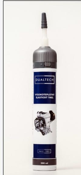
Tepelná odolnosť až do 180 °C, krátkodobo do 220 °C. Aj po vytvrdení si zachová svoju trvalú elasticitu. Má výbornú prilnavosť k väčšine kovov a plastov. Patentovaný systém zabezpečí racionálne a jednoduché použitie. Používa sa v pravýrobe automobilov, lodí, čerpadiel. Vhodná pre opravy motorov, kompresorov aj karosárské práce, taktiež pre rôzne tesnenia vo výrobe zariadení, klíma techniky.
